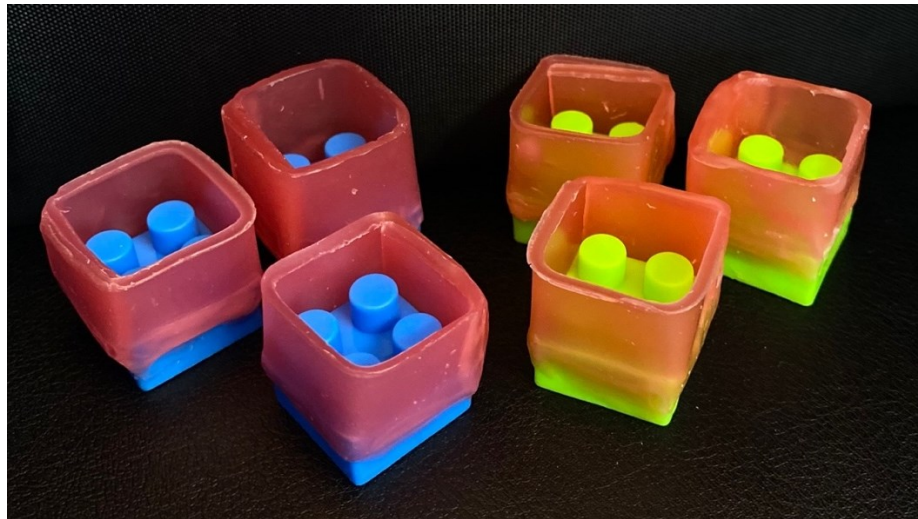
Ilustración 3, Formaletas en cera rosada para ser ubicados sobre un bloque de fichas de arma todo o plásticos prefabricados (Lego), Fuente: Autores.
