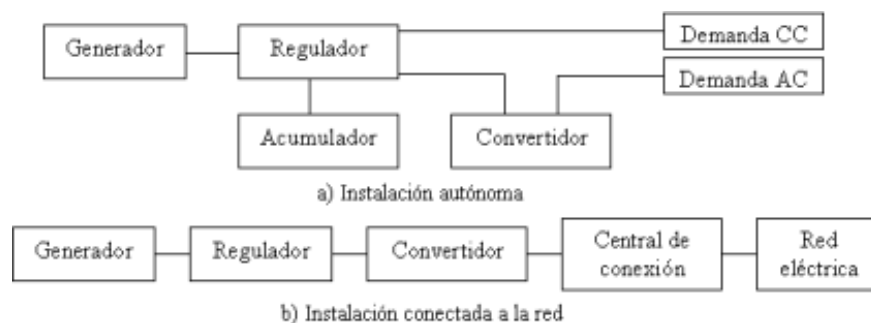
Figura 4-12. Instalación autónoma y conectada a la red.
