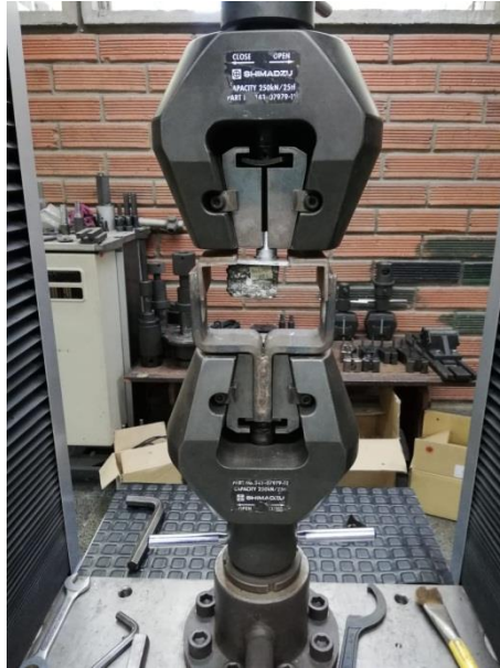
Figura 4-7: Montaje para la prueba de tensión.
