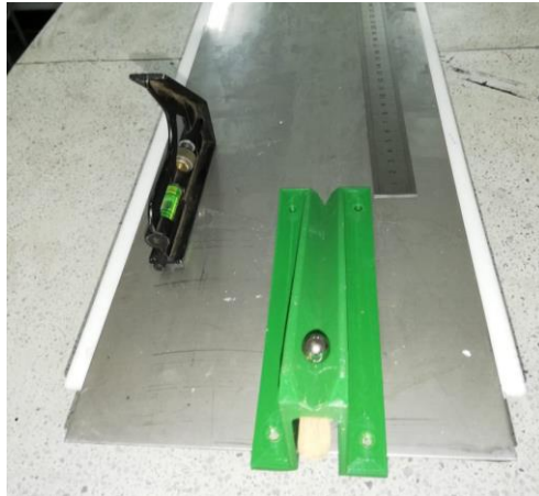
Figura 4-5: Montaje para la prueba de pegajosidad.
