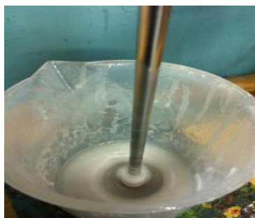
Figura 2-8: Disolución de EPS en acetato de etilo.
