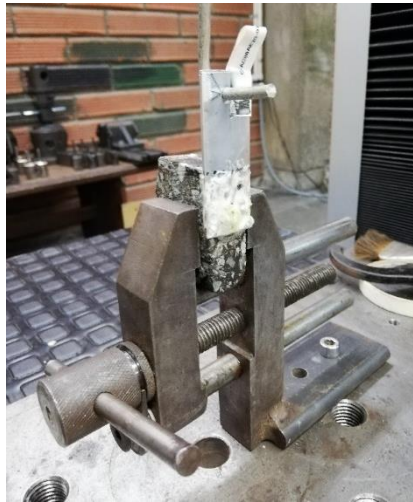
Figura 4-6: Montaje para la prueba de cortante.
