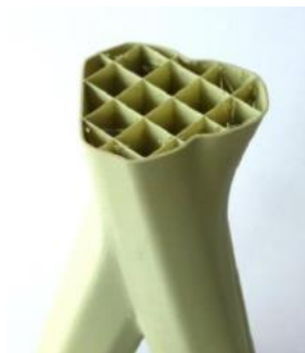
Figura 6. Estructura interna de una pieza impresa en 3D
