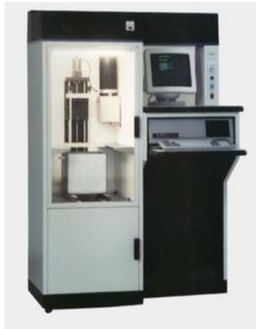
Figura 2. La primera impresora 3D, la impresora de estereolitografía SLA-1 Fuente. (Rodríguez, 2018)
