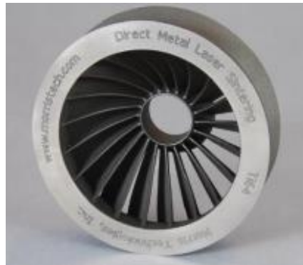
Figura 11. Compresor fabricado mediante DMLS Fuente. (Rodríguez, 2018)
