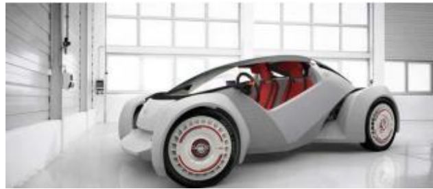
Figura 9. Vehículo fabricado con una impresora 3D Fuente. (Rodríguez, 2018)
