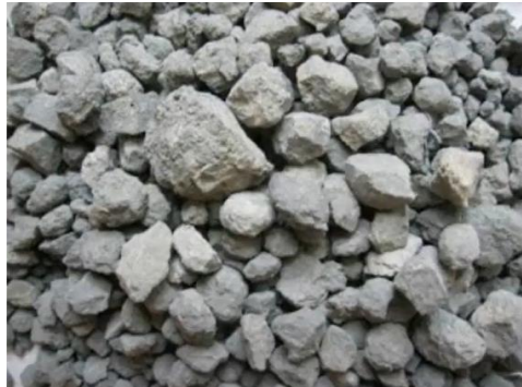
Figura 10 Resultado del proceso de clinkerización , granulos de clinker
