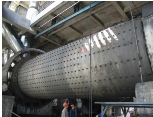
Figura 11 Molino de rebestimiento de acero, proceso de molienda final
