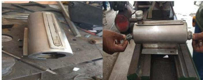
**Figura 14** – modificación de tanque de combustible en acero inoxidable.
