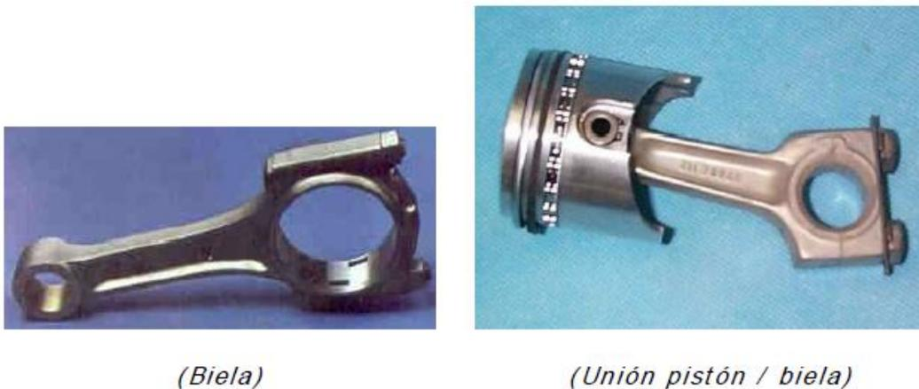
Figura 9 – Biela de un motor – Documento motores de combustión interna [16]
