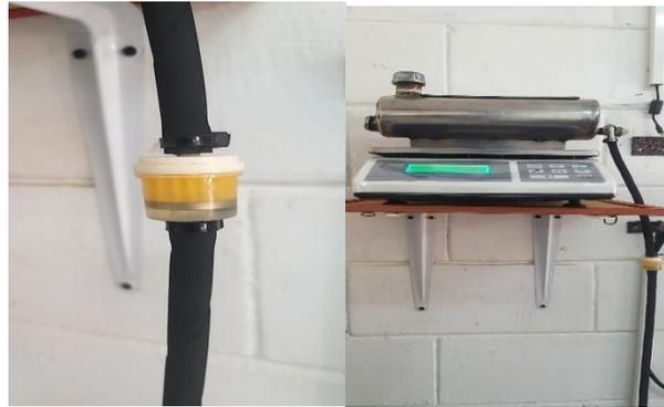
Figura 15 – Sistemas de filtrado de combustible
