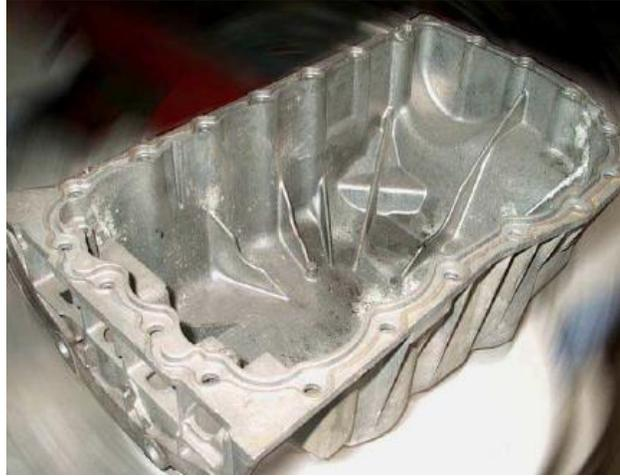
**Figura 10** – Cartes de un motor – Documento motores de combustión interna [16].
