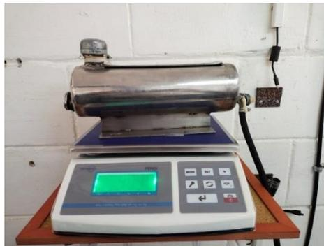
Figura 20 – Sistema demedicion de combustible Tanque de almacenamiento – Bacula TRÚMAX
