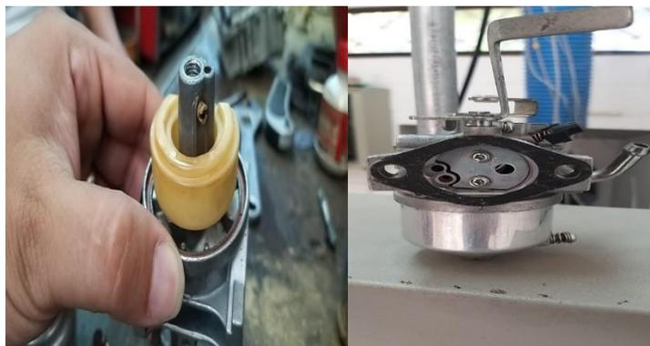
Figura 16 – Mantenimiento a carburador del Generador YAMAHA
