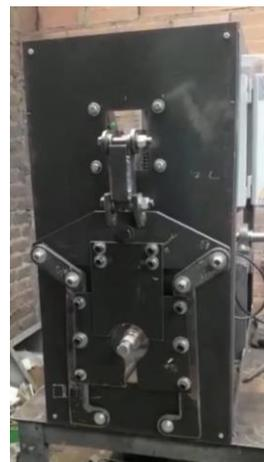
Después de verificar que cada elemento que compone la máquina cumpla con su función al realizar el arranque, se procede a insertar un tubo en la máquina y verificar que el ajuste sea correcto para llevar a cabo el proceso (Figura 65), una vez se comprueba lo anterior se da inicio al proceso de doblado de un primer tubo, con esto también se busca probar el funcionamiento de los moldes.
