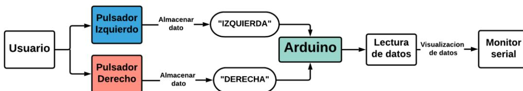
Las variables anteriormente almacenadas: “IZQUIERDA” y “DERECHA” son llamadas desde la plataforma Unity mediante unas librerías las cuales permiten acceder al puerto serial. Se cargan estos valores y se los enlaza con las animaciones del videojuego las cuales permiten el cambio de dirección del personaje principal dentro del entorno virtual.
