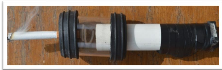
Figura 9. Dispositivo simulador de la cavidad oral.
