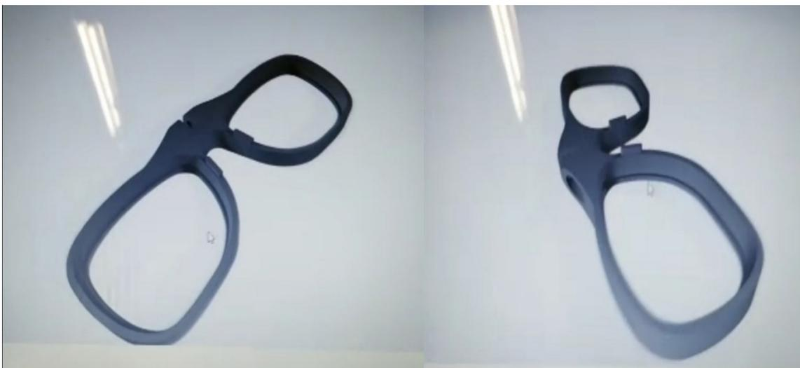
**7.6 Dispositivo en ABS (Impresión 3D) con lentes montados en material Trivex®, antirreflejo y Transition®**
