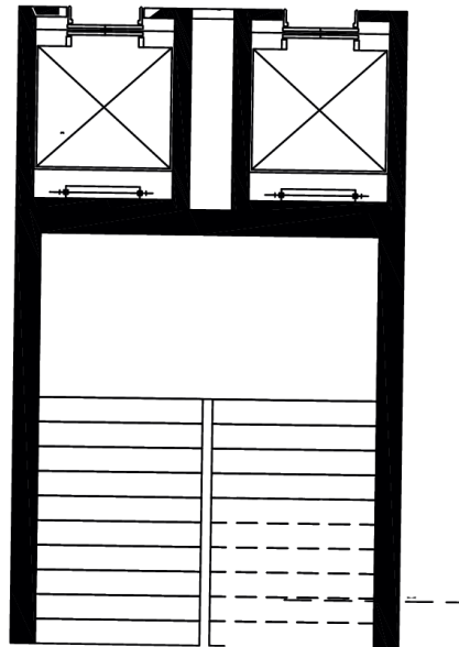
Figura 7: Muros robustos para puntos fijos
