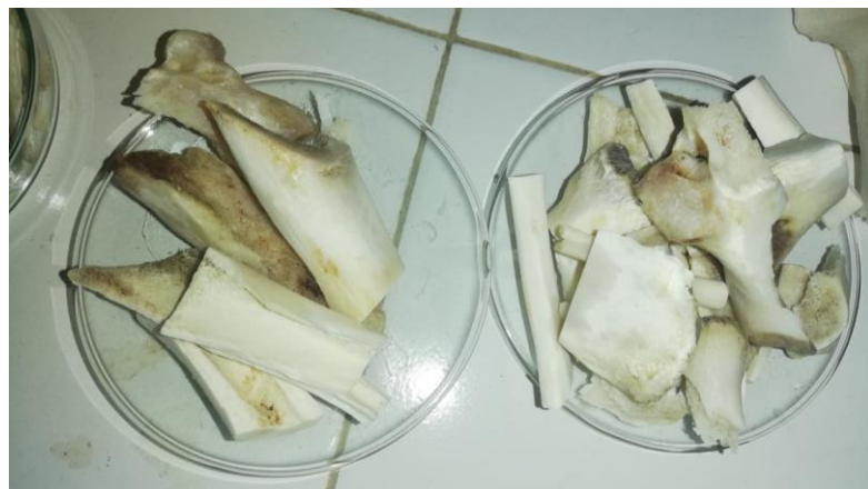
Figura 3-3 Huesos posterior a su inmersión en acetona, lavado (agua destilada) y secado en mufla durante 1 h a 100 °C
