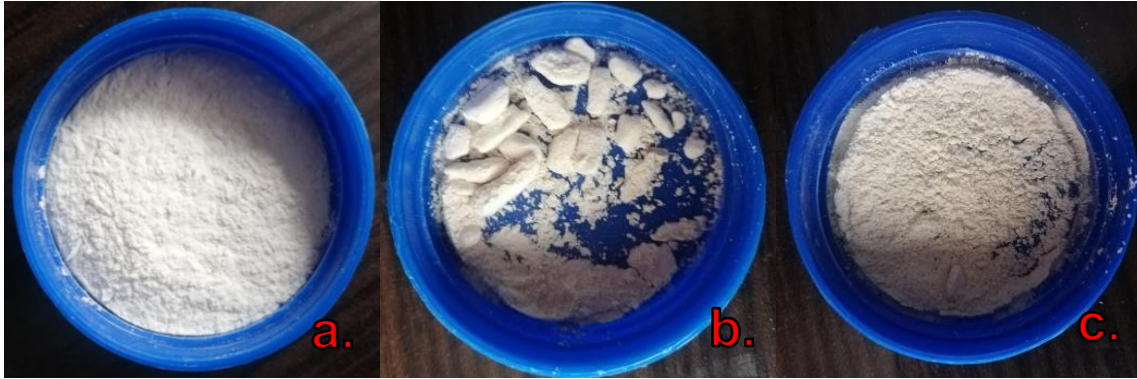
Figura 4-3 Primera serie experimental, a) HA1, b)HA2 y c)HA3 con condiciones de molienda: w_p = 400, 500 y 650 rpm respectivamente, m_b:m_p = 20:1 ( N_b = 20 bolas) y t = 2 h. En la figura 4-3 se observan las muestras correspondientes a HA1, HA2 Y HA3, que fueron sometidas a diferentes velocidades de giro del disco. A partir de principio de la molienda como método de síntesis y la maleabilidad de los polvos obtenidos, es posible deducir que, a mayor energía entregada, las partículas sufren un proceso de cohesión y aglomeración.
