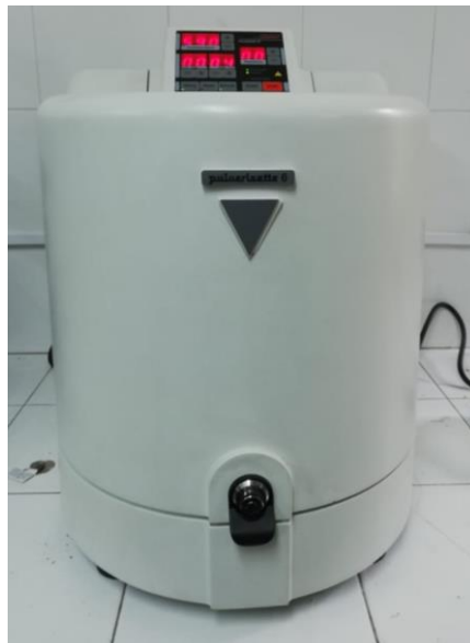
Figura 2-6 Molino planetario PULVERISITTE 6 classic line. Molino existente en la Universidad Antonio Nariño- Sede Tunja
