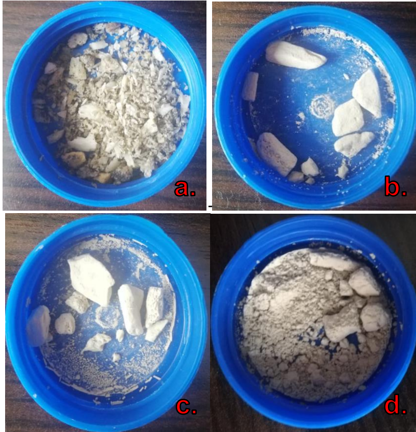
Figura 4-5 Segunda serie experimental, condiciones de molienda: w_p=650 rpm, m_p:m_b= 20:1 y 0 < t < 8 h.
