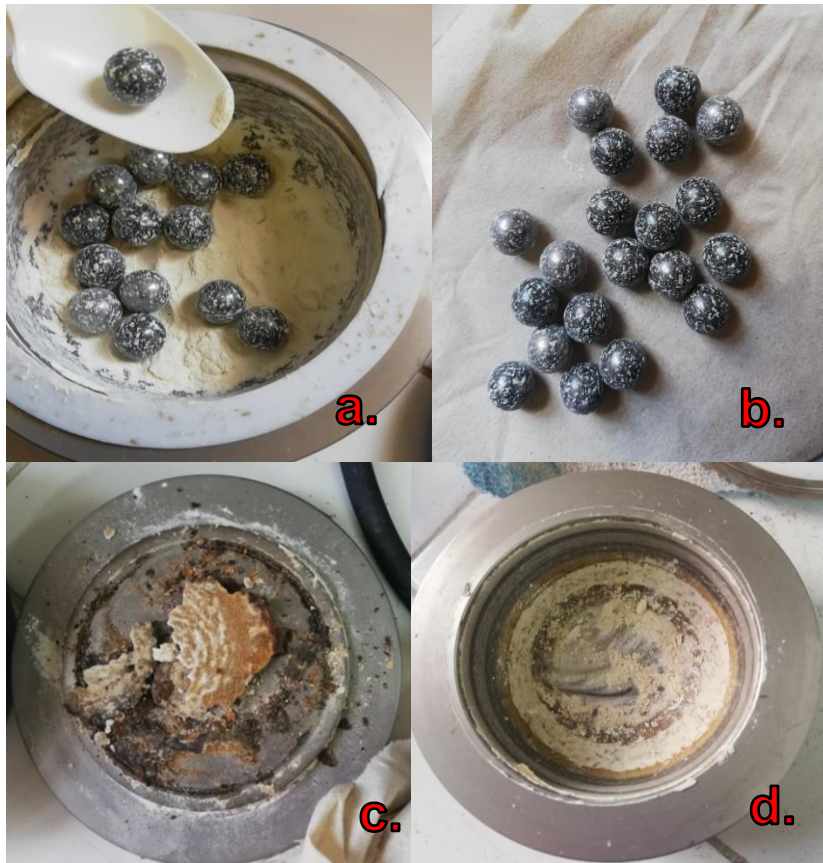
Figura 4-4 Efectos del incremento de la velocidad de giro del disco en la muestra (a), bolas (b) y jarro (c y d)
