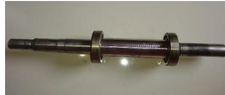
Figura 2. Instalación de rodamientos los cuales adsorben las cargas radiales y axiales.
