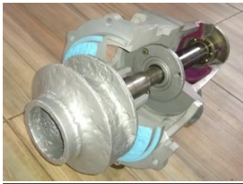
Figura 6. Montaje de la tapa interna de la carcasa y del impulsor KWP tipo K, que transforma la energía mecánica en energía cinética
