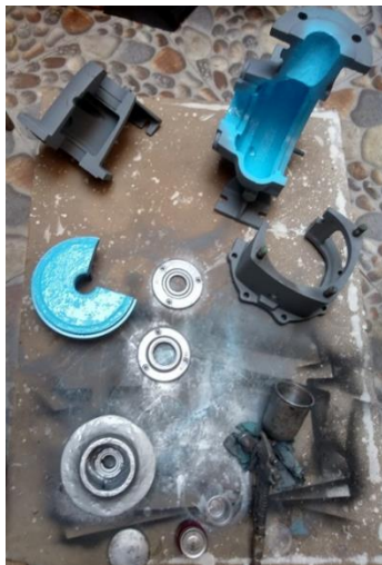
Figura 1. Proceso de sandblasting, que consiste en lanzarle arena a presión para remover la corrosión.
