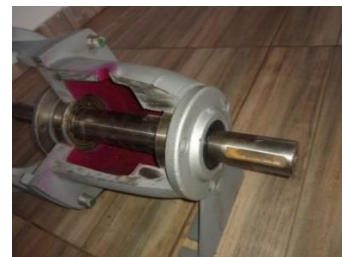
Figura 4. Montaje de la flecha con los rodamientos en el la cámara de lubricación.
