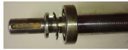
Figura 3. Instalación de la tuerca de seguridad en el lado acople del rodamiento.
