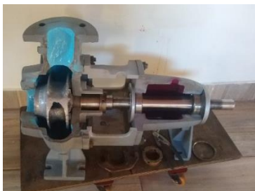
Figura 7. Montaje de la carcasa, que es la encargada de direccionar el líquido.
