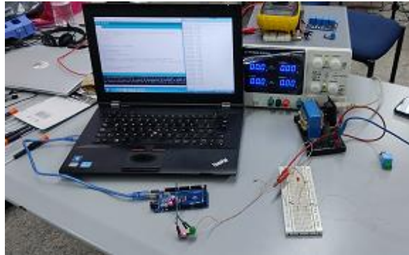
Figura 12. Verificación y prueba del sensor de Corriente ACS712ELCTR-30A-T
