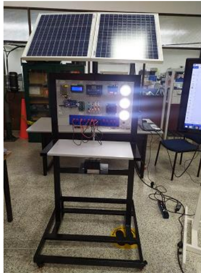
Figura 35. Módulo de mediciones de variables eléctricas
