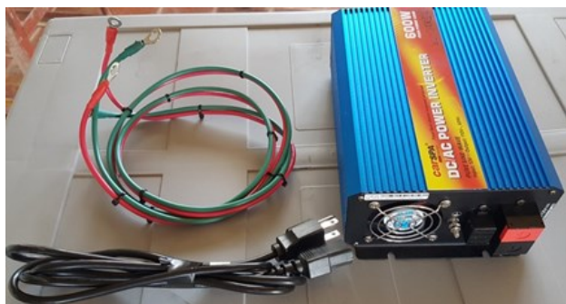
Figura 2-7: Inversor CarSpa de 600W con sus cables. Fuente: Autores.
