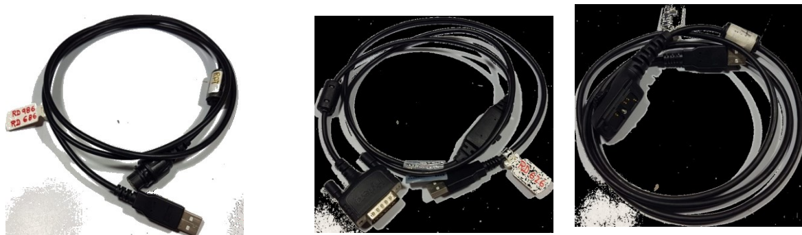
Figura 3-17: Cables de programación. Fuente: Autores
