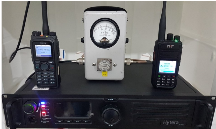
Figura 3-15: Medición de potencia del repetidor maestro Fuente: Autores
