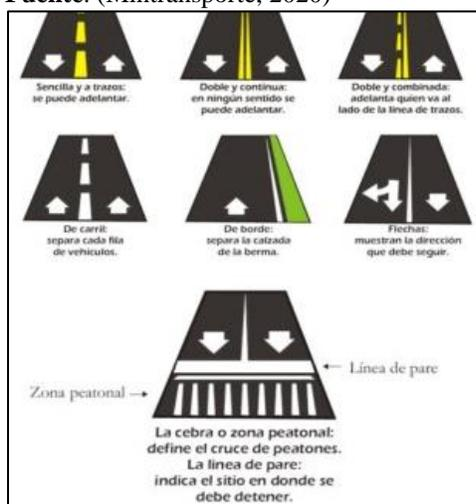
Figura 11. Ejemplos de Señales horizontales o marcas viales
