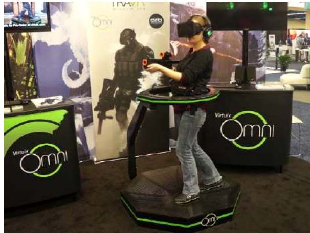
Figura 2-4: Usuario Virtuix Omni, plataforma la cual interactuaría con las gafas de realidad virtual Oculus
