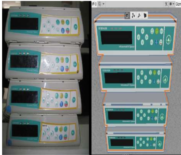
Figura 4-5: Bombas de infusión Braun Space- Infusomat real - Diseño en 3D(VR)
