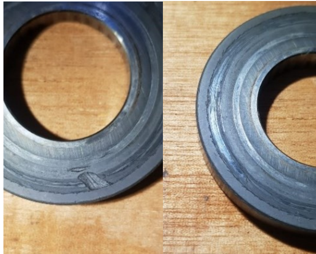
Figura 19. Efectos de la erosión en las caras de los sellos mecánicos
