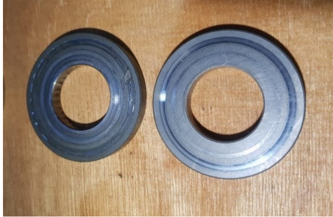
Figura 18. Comparación cara de sello mecánico que ha sufrido picadura (Lado izquierdo), cara de sello mecánico que está en correcto estado (lado derecho).
