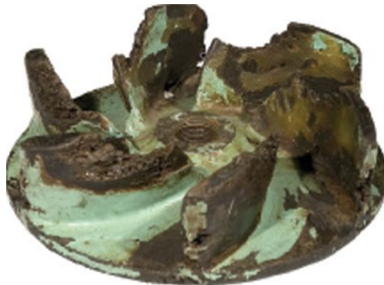
Figura 10. Efectos de la cavitación sobre impulsor abierto [28]
