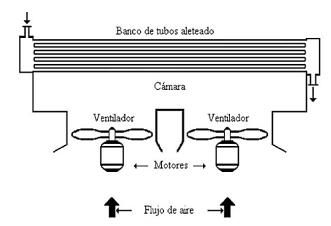
**Fuente:** (APRENDE MAS sobre el chiller enfriado por aire DETALLES TECNICOS, s. f.)
