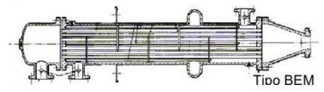
Fuente: Hidroterm: intercambiador de cabezal flotante interno.
