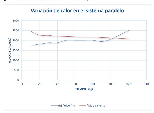
Figura 40. Variación del calor en el fluido caliente y frio
