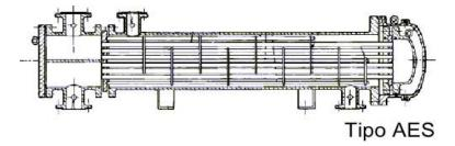
Fuente: Hidroterm: intercambiador de cabezal flotante interno.
