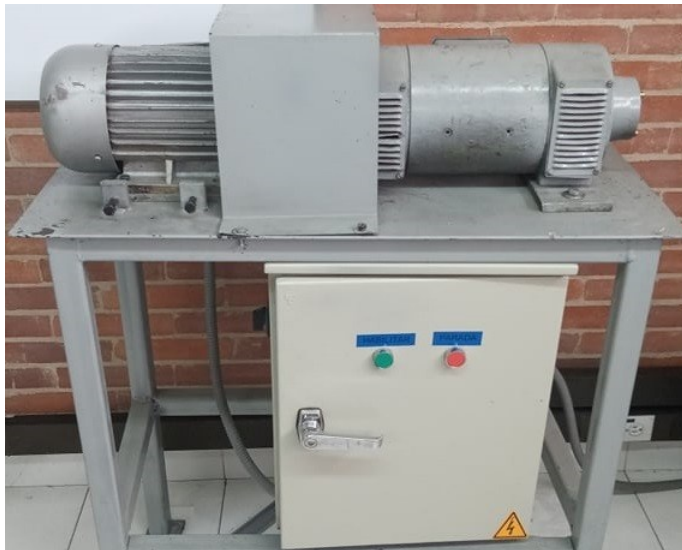
Figura 6-2: Banco de pruebas para la simulación de fallas en un motor de inducción
