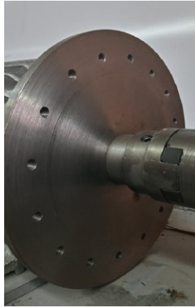
Figura 6-5: Disco para incorporar pesos y generar desbalance del motor
