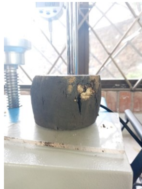
Figura 5-12: Fallo muestra de arcilla
