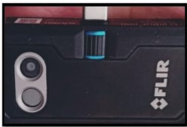
Figura 21. Cámara térmica, modelo FLIR ONE PRO. Fuente: elaboración propia.
