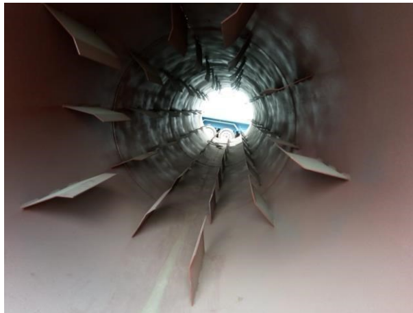
Figura 3-5: Foto Aspas al interior del horno rotativo
