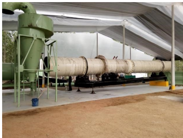
Figura 3-4: Foto horno rotativo
