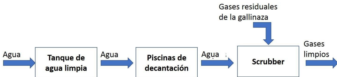
Figura 3-7: Sistema de extracción y lavado de gases
