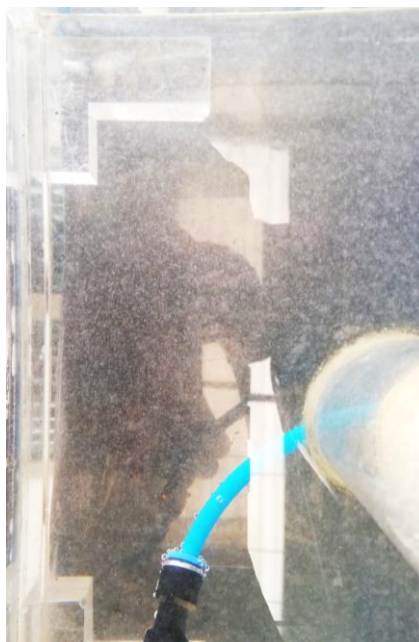
Figura 48: Efervescencia y espumosis al generar microburbujas
