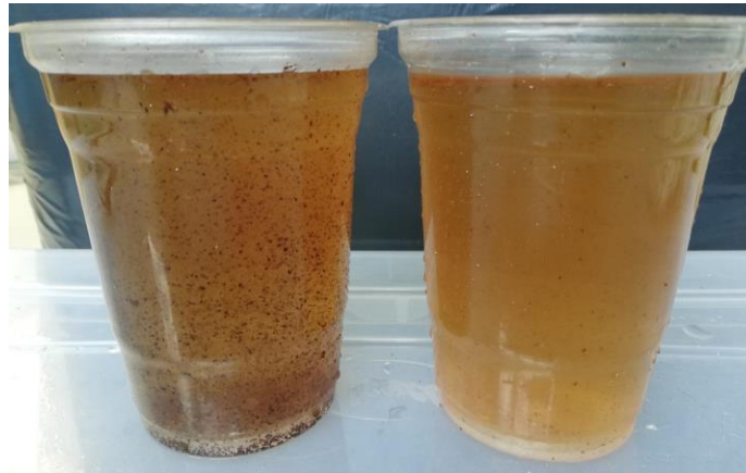
Figura 36: Diferencia en los sedimentos de café con un paso por el hidrociclón, al lado izquierdo salida de mezcla para reinicio de proceso y al lado derecho salida de agua tratada con un paso por hidrociclón
