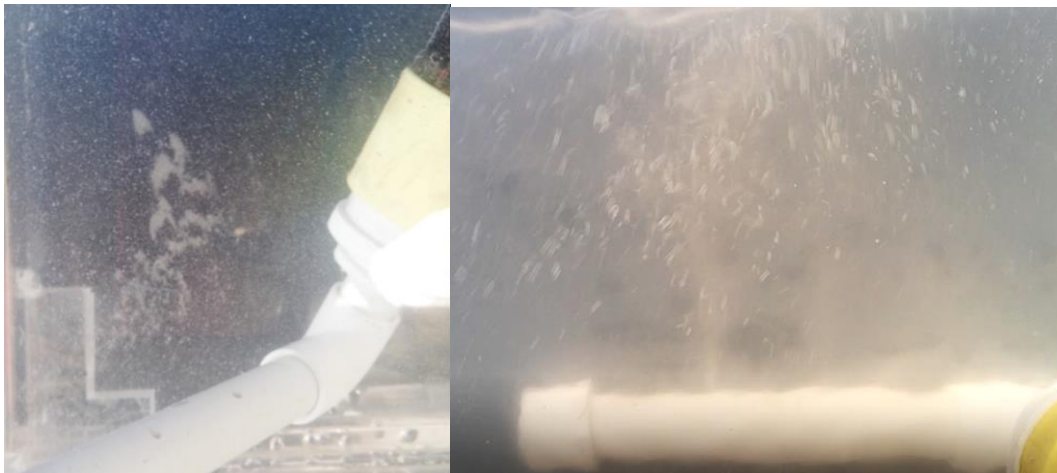
Figura 46: Ejecución del burbujeador helicoidal. Espumosisidad al lado izquierdo, nube blanquecina imagen del lado derecho
