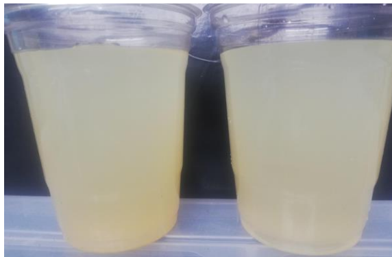
Figura 49: Aplicación de microburbujas a arena, al lado izquierdo mezcla extraída después de un paso por el hidrociclón y al lado derecho agua luego de un paso por el hidrociclón y aplicación de las microburbujas
