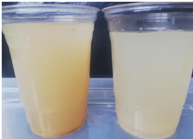
Figura 35: Muestras de salidas del hidrociclón, a la izquierda mezcla de agua y sedimentos para reinicio del proceso y a la derecha resultado desarenado de un paso por el hidrociclón
