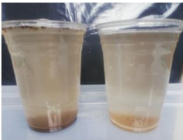
Figura 38: Muestra de resultados provenientes del hidrociclón permitiendo asentamiento de sedimentos
