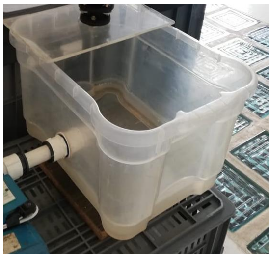
Figura 29: Tanque almacenamiento de agua con sedimentos
