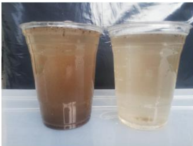
Figura 37: Muestra de cambio en resultados luego de un paso por el hidrociclón (lodo), lado izquierdo mezcla para reinicio de proceso, lado derecho resultado después de un paso por el hidrociclón
