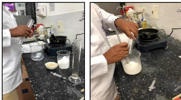
Figura 8. Se agrega a la mezcla el plastificante y el aditivo.
