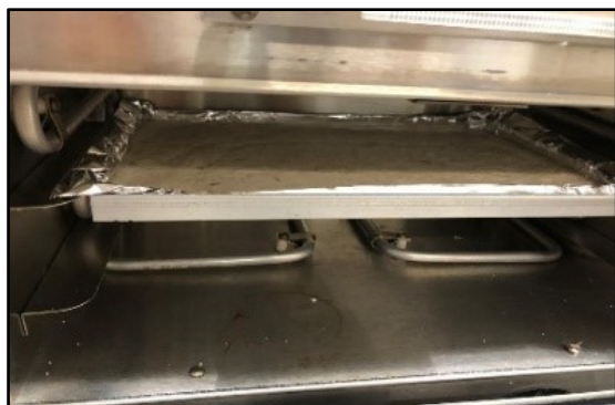
Figura 11. Molde rectangular con una composición en el horno steri-dent.
