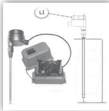
Figura 47: Medidor de nivel capacitivo Fuente: (Creus, 2010)
