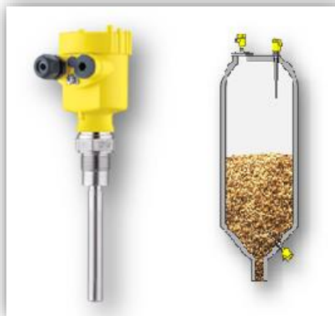
Figura 53: Interruptor de nivel vibratorio para sólidos granulados
