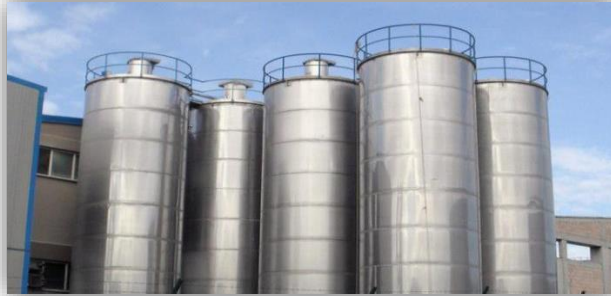
Figura 7: Silos de torre de bajo oxígeno Fuente: (Nextews)
