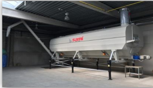
Figura 11: Silos aéreos horizontales Fuente: (Sami)
