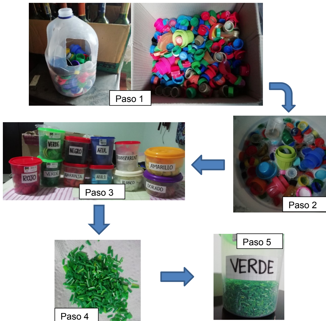
Figura 2-1. Preparación del PP.
