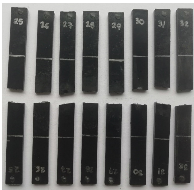
Figura 3-13. Probetas de PPGC 3010 luego de aplicar el ensayo mecánico de flexión.
