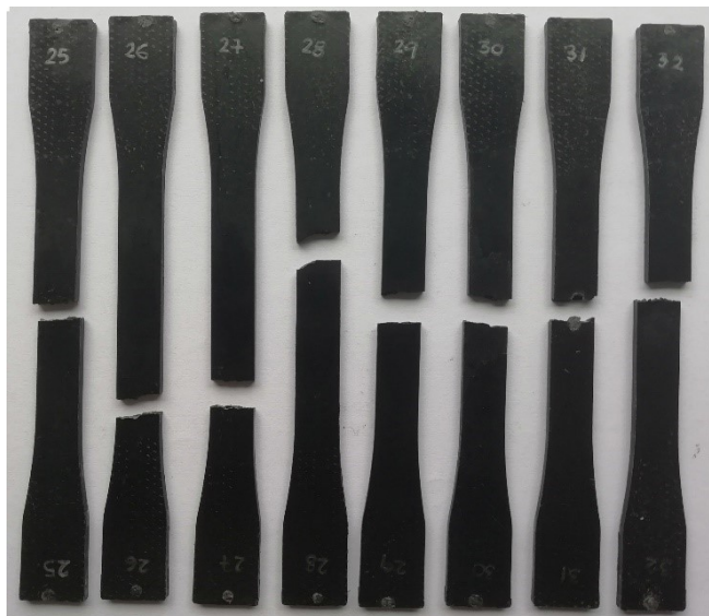
Figura 3-7. Probetas de PPGC 3010 luego de aplicar el ensayo mecánico de tensión.
