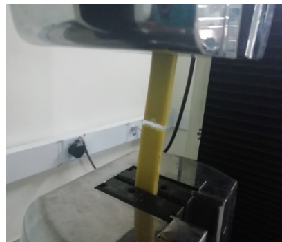
Figura 3-3. Prueba preliminar calibración de la máquina de ensayos universal.
