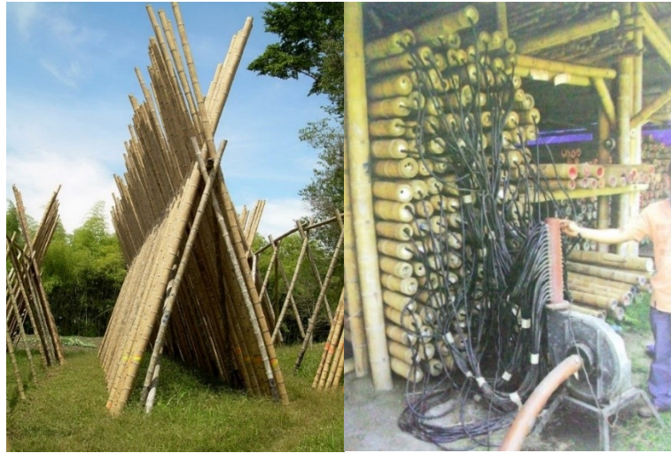
Figura 1-15. Secado por aire en forma de trípode (izquierda) y por aire caliente (derecha).
