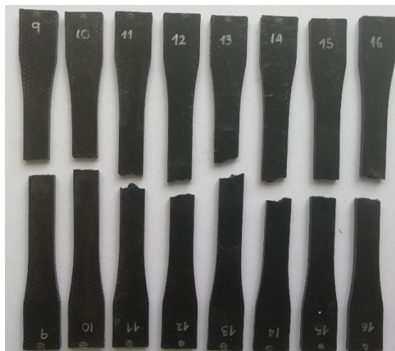
Figura 3-5. Probetas de PPGC 3505 luego de aplicar el ensayo mecánico de tensión.
