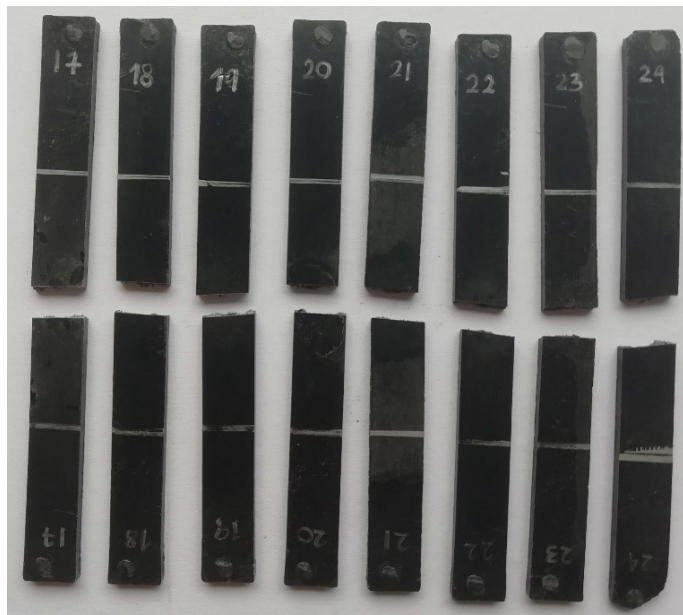
Figura 3-12. Probetas de PPGC 3307 luego de aplicar el ensayo mecánico de flexión.
