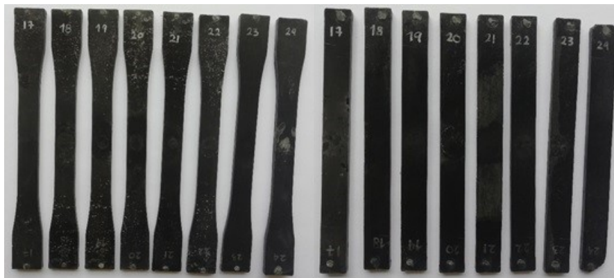
Figura 2-7. Probetas de tensión (izquierda) y flexión (derecha) de PPGC 3307
