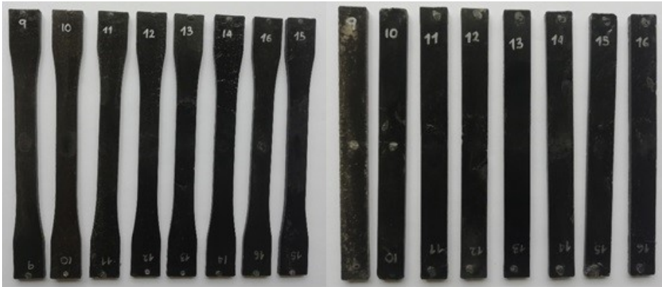
Figura 2-6. Probetas de tensión (izquierda) y flexión (derecha) de PPGC 3505
