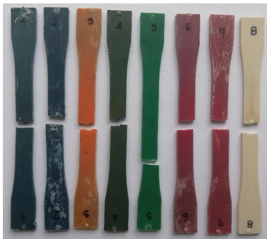
Figura 3-4. Probetas de PP100 luego de aplicar el ensayo mecánico de tensión.
