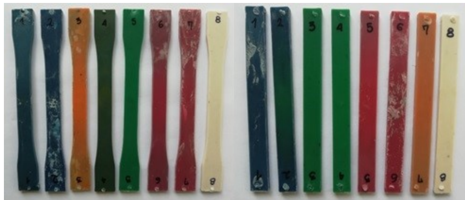
Figura 2-5. Probetas de tensión (izquierda) y flexión (derecha) de PP 100
