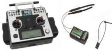
Ilustración 22 Control de 12 Canales Fuente: (Mercado libre)
