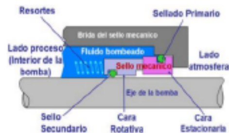
Figura 2. Principio básico del sello mecánico. [10].
