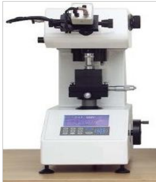
Gráfica 8. Microdurómetro Vickers [13]
