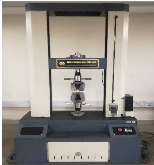
Gráfica 6. Maquina universal de ensayos laboratorio UAN. Fuente propia
