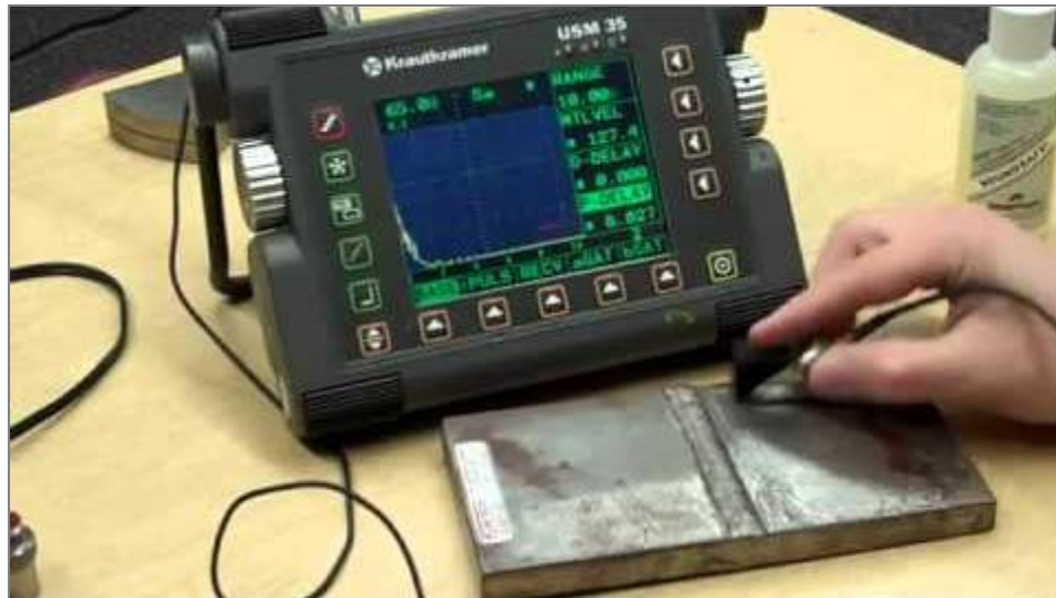
Gráfica 14. Aplicación prueba ultrasonido [17].
