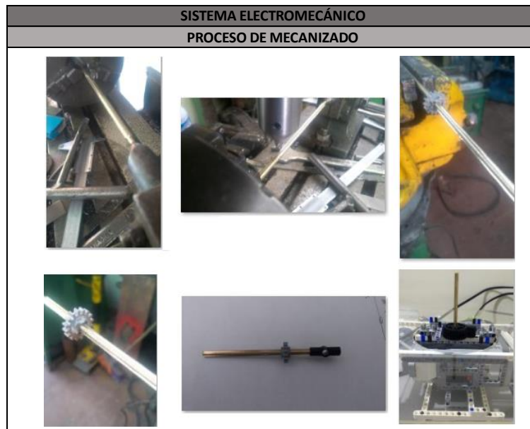
Figura 30. Mecanizado de ejes especiales. Fuente:(Propia).
