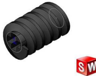
Figura 21. Tornillo sin fin, Diseño en SolidWorks. Fuente. (Propia).
