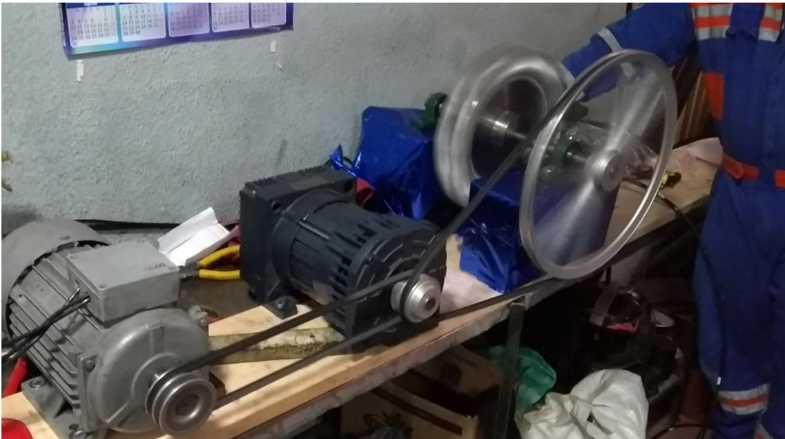
Figura 76. Acople entre el motor, el generador, la rueda Pelton. [Fuente propia]
