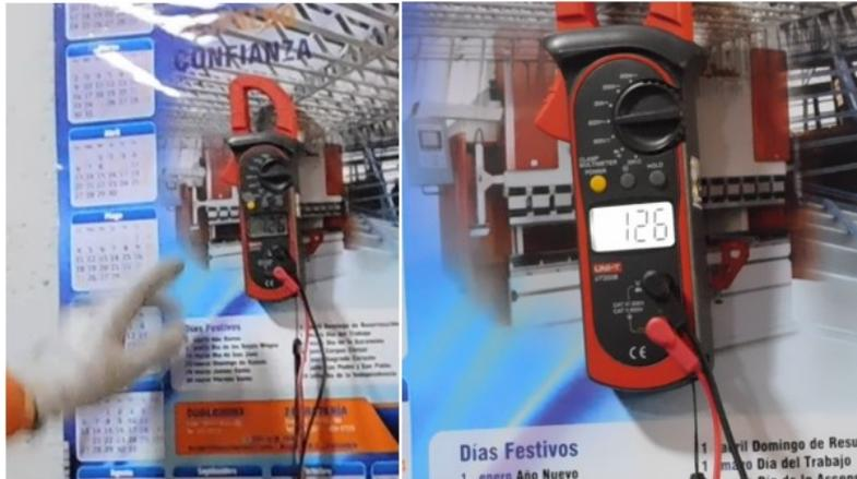
Figura 77. La pinza voltiamperimétrica permite visualizar el voltaje que se obtiene a la salida del generador (126V). [Fuente propia]
