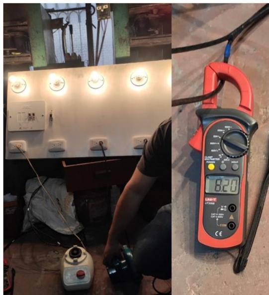
Figura 84. Corriente requerida para soportar la potencia conectada al banco. [Fuente propia]
