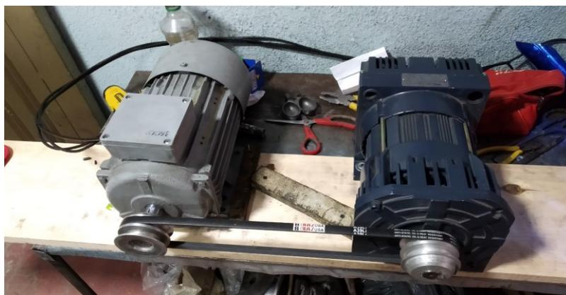
*Figura 69. Unión por medio de poleas entre un motor eléctrico trifásico, lado izquierdo y un generador monofásico, lado derecho. [Fuente propia]*
