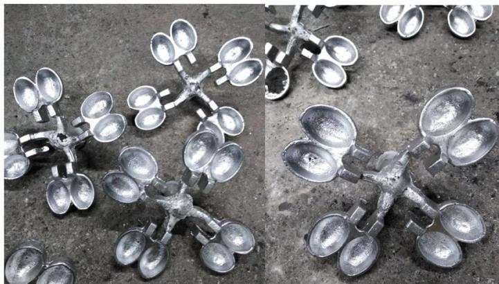
Figura 36. Alabes terminados, en comparación con los alabes del primer diseño, estos cuentan con un mejor acabado y un punto de fijación adicional. [Fuente propia]
