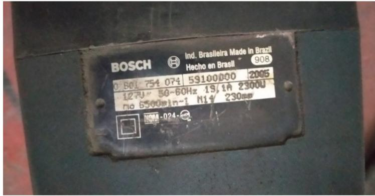
Figura 74. Ficha técnica de una pulidora 127V, 2300W, 50-60Hz. [Fuente propia]
