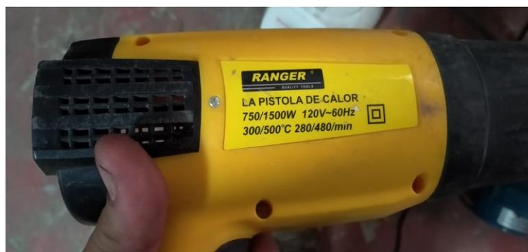
Figura 73. Ficha técnica de una pistola de calor 120V, 750-1500W, 60 Hz. [Fuente propia]
