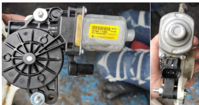
*Figura 68. Servomotor que operara válvula de control para el bypass. [Fuente propia]*
