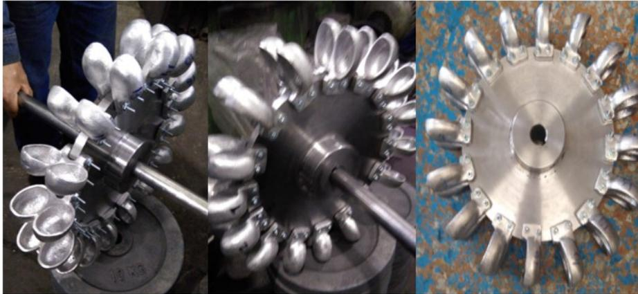
Figura 58. Estructura finalizada de la rueda Pelton. [Fuente propia]
