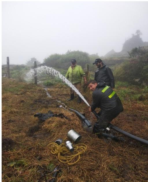
Figura 33. Determinación de la distancia alcanzada y velocidad recorrida del fluido. [Fuente propia]
