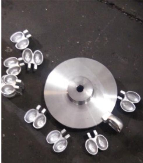
*Figura 55. Plato y alabes después del proceso de pulido. [Fuente propia]*
