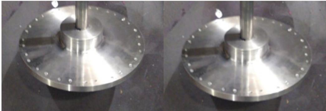
*Figura 56. Plato mecanizado y perforado. [Fuente propia]*
