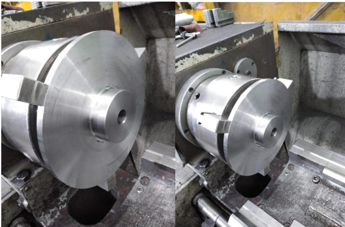
*Figura 54. Proceso de mecanizado y balanceo de la rueda que soportara el conjunto de alabes para la rueda Pelton. [Fuente propia]*
