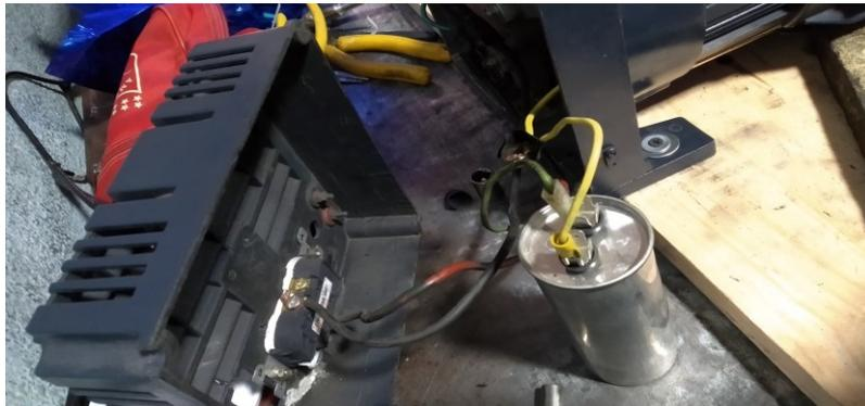
*Figura 87. Condensador del generador 70µF, 340VA. [Fuente propia]*
