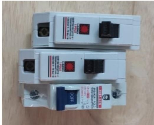
Figura 61. Protecciones termomagnéticas. [Fuente propia]
