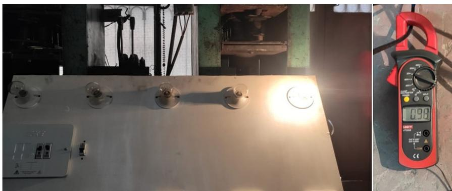
Figura 78. Corriente obtenida para la carga instalada de un bombillo. [Fuente propia]
