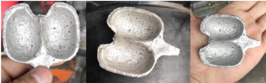
Figura 35. Alabes después del proceso de fundición. [Fuente propia]
