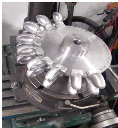
*Figura 57. Armado de la rueda y de los alabes para dar forma a la estructura tipo Pelton. [Fuente propia]*
