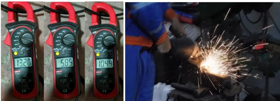
Figura 86. Valores de corriente en función del uso de una pulidora industrial. [Fuente propia]
