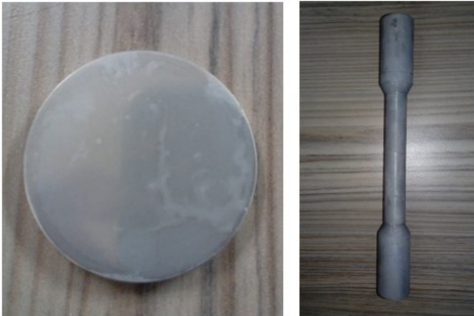
Figura 7: Fotografías de los especímenes maquinados luego de ser tratados térmicamente
