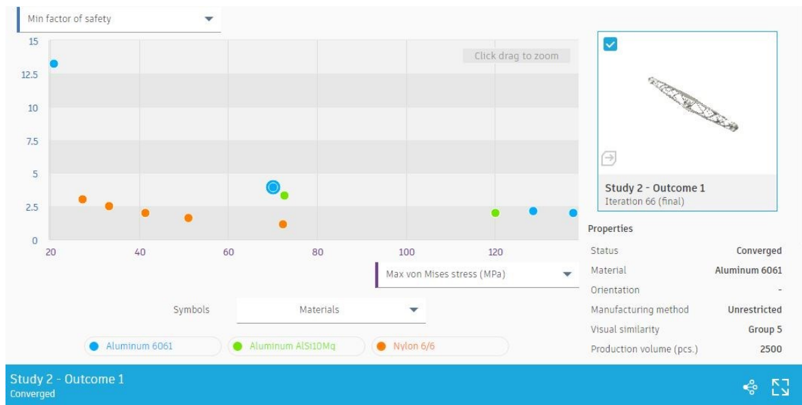
Figura 5-20: Diagrama de dispersión de puntos, mín factor de seguridad contra el esfuerzo máx. Von Mises
