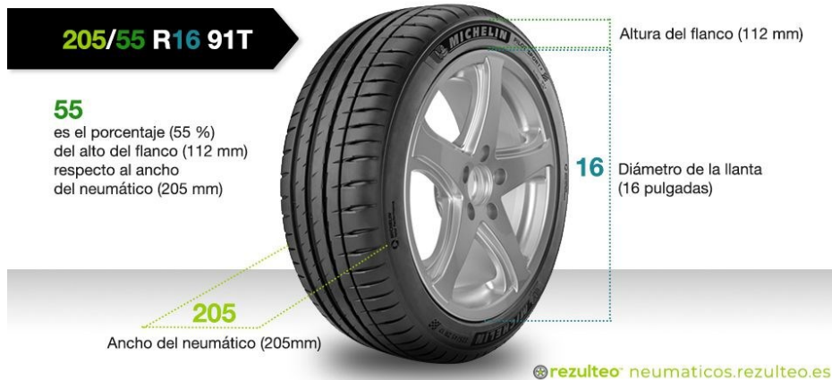
Figura 3-9: Designación de las dimensiones de un neumático
