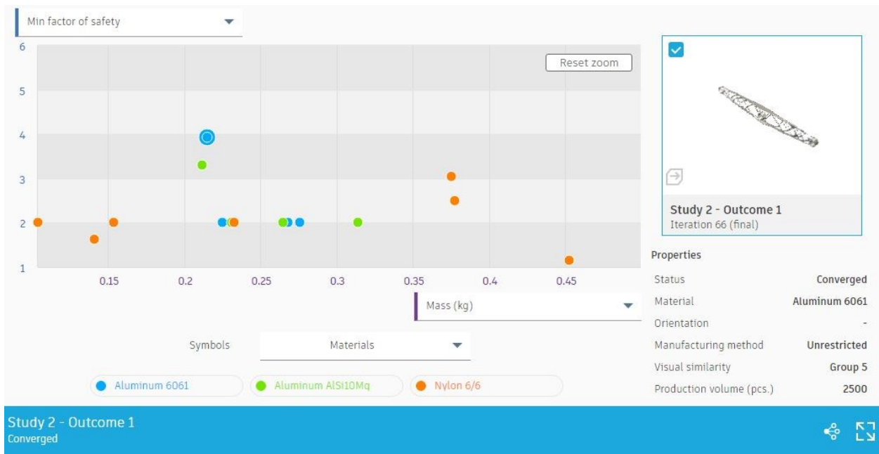
Figura 5-19: Diagrama de dispersión de puntos, min factor de seguridad contra la masa 2
