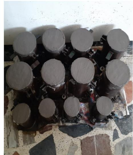
**ENSAYO DE LA RESISTENCIA A LA COMPRESIÓN DE LOS ESPECIMENES ELABORADOS CON AGUA
