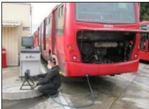
Ilustración 11: Medición de opacidad con opacímetro. Fuente: Transmasivo S.A
