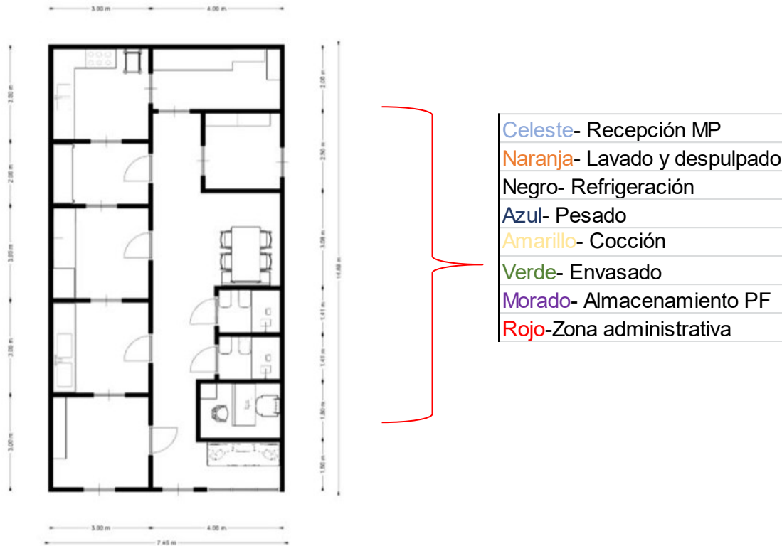
Ilustración 15 Distribución Planta de Producción
