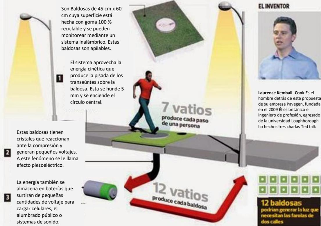
Figura 45. *Funcionamiento de la Baldosa Pavegen*
