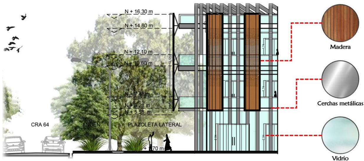
*Figura 44.* Detalle en alzado materialidad en fachada. Fuente: Elaboración propia
